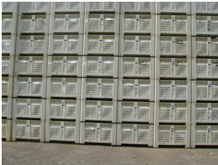
Figura 2.5. Estiba de bins sin separación entre bandas.
