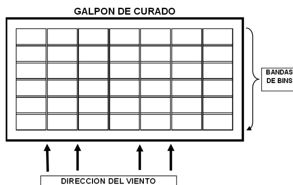
Figura 2.2. Orientación y largo de las bandas de bins en el galpón de curado.
