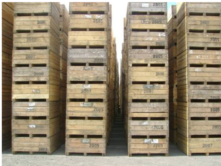
Figura 2.6. Estiba de bins no recomendable por separación entre bandas.
