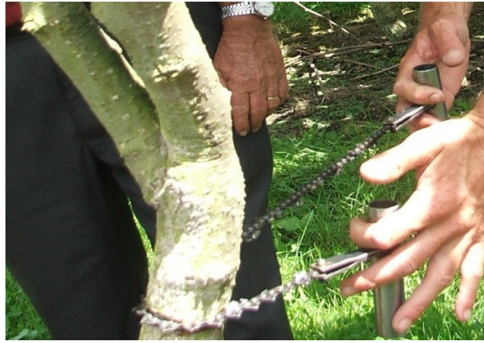
Figura 17.5. Cadena de motosierra con dientes gastado
