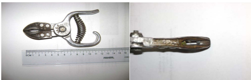
Figura 17.3. Tijera para anillado de laterales en kiwi.
